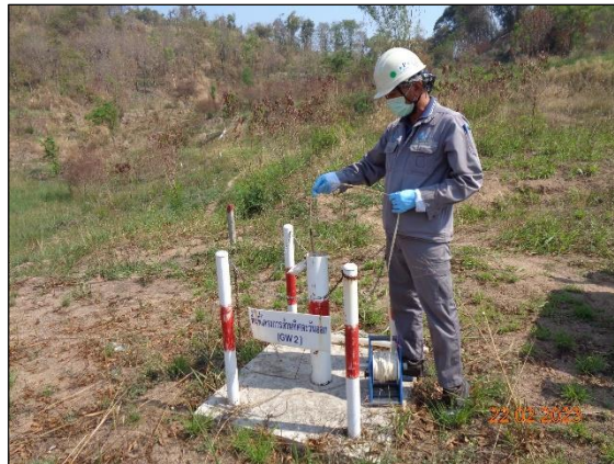
รูปที่ 3.13 ป้อนตรวจคุณภาพน้ำใต้ดิน บริเวณพื้นที่โครงการด้านทิศตะวันออก (GW2)
